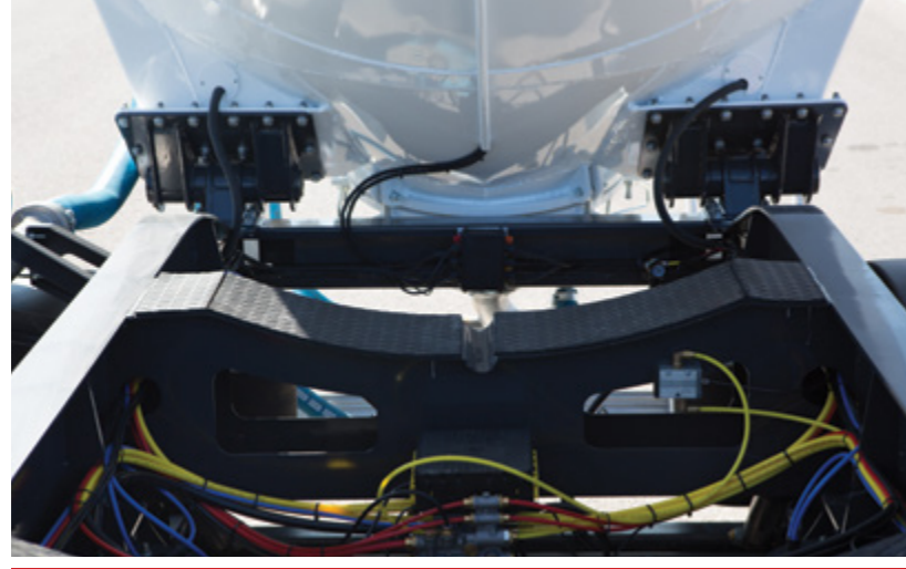
Renkli, POLYAMIDE hava hortumları Tesisat kablolarında karmaşayı önler, servis kolaylığı sağlar
