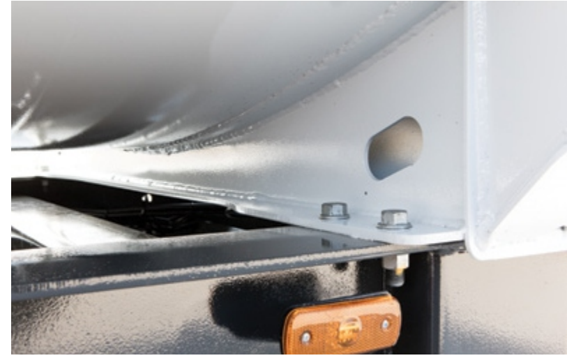
OMEGA® monoblok bağlantı semerlerinde sinerjik kaynak teknolojisi kullanımı Şasi birleşim noktalarında gövde mukavemetini arttırır, gerilim etkisini azaltır, gövdeyi yekpare kavramasını sağlar
