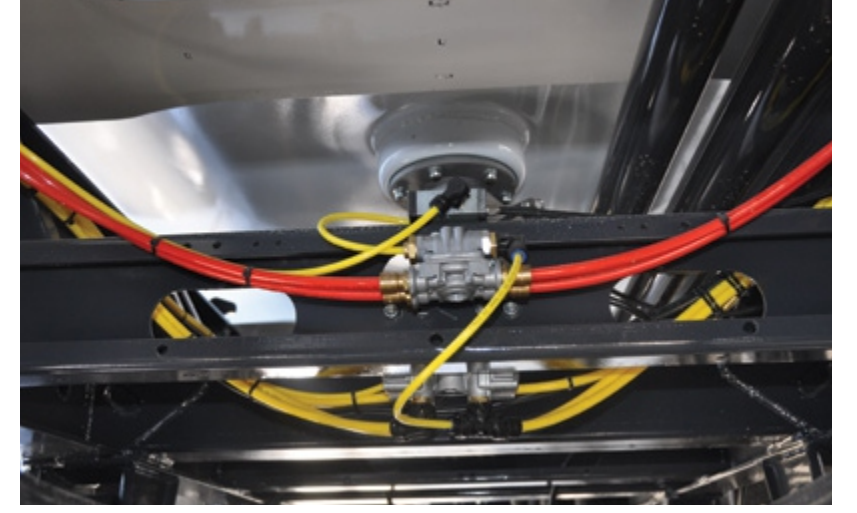
Renkli, POLYAMIDE hava hortumları Tesisat kablolarında karmaşayı önler, servis kolaylığı sağlar
