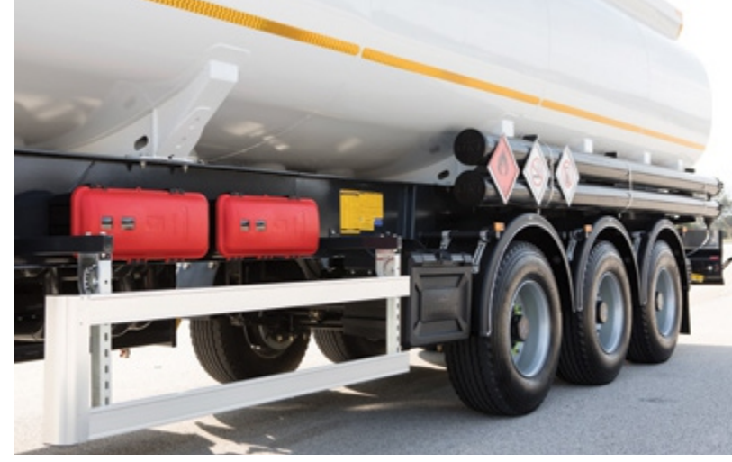
Eğimli şasi tasarımı Tank gövdesi içerisinde sıvı kalmayacak şekilde tam boşaltım sağlar
