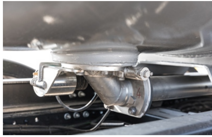
Derin çekme yöntemiyle açılan çıkışlar Tankın alt kısmında, içerisinde ürün kalmayacak şekilde tam boşaltım sağlar
