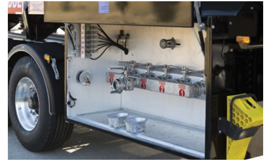
Armatür dolap kapağı (Otobüs bagaj kapağı tipi) Dar alanda hareket kabiliyeti ve ergonomik kullanım sağlar
