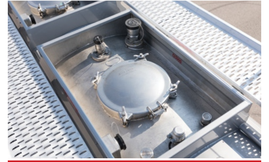
Spilltrays tip dökülme havuzu Olası devrilme ve darbelere karşı armatürlere koruma sağlar
