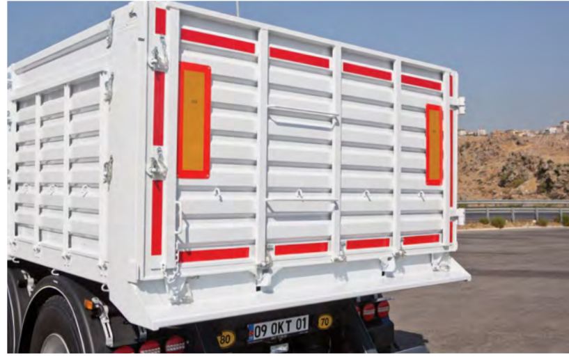
Kendinden ve yana açılır arka kapak Boşaltım sırasında yükün akışını kolaylaştırır
