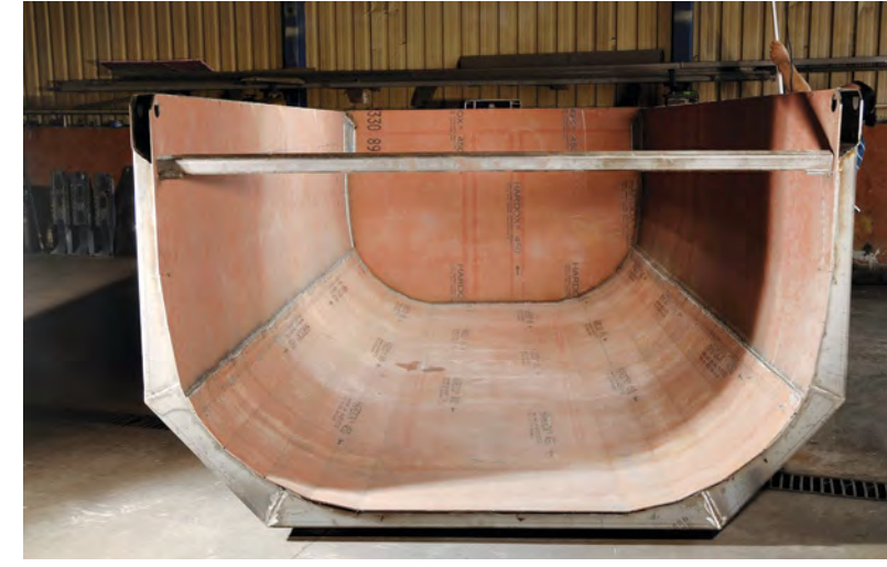
Bindirme Kaynak metodu ile güçlendirilmiş birleşim noktaları Uzun ömürlü, kuvvetli gövde yapısı
