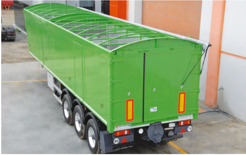
özel panel geçme yan alüminyum duvarlar Yüksek dayanım
