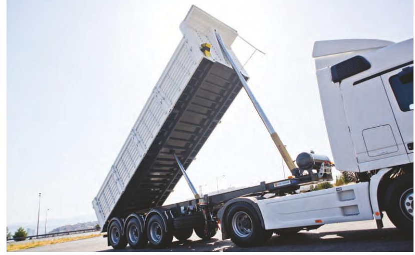
Hidrolik Sistem Boşaltım açısını sağlar, hızlı ve kolay boşaltır
